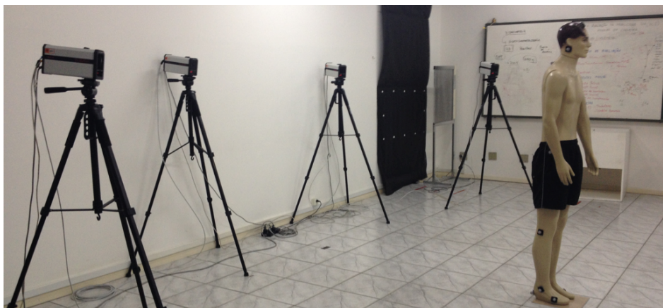
Figura 4: Instrumentação para coleta dos dados de cinemetria composta de quatro câmeras infravermelhas e o manequim utilizado para avaliação do sistema.
