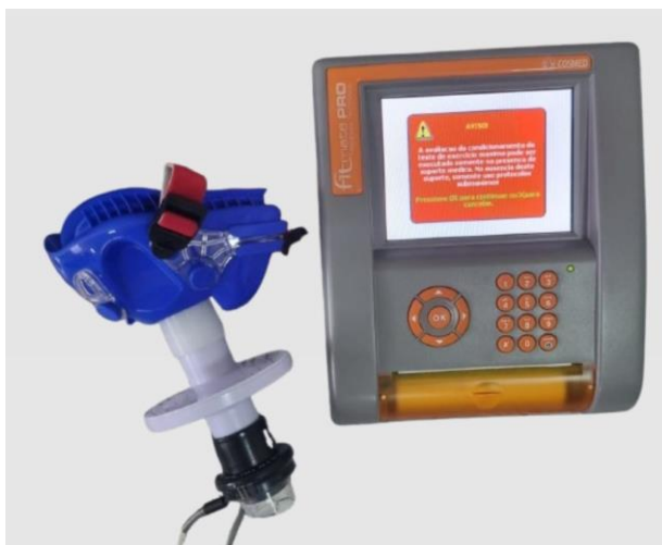
Figura 1 – Analisador metabólico de gases (FitMate - Cosmed, Roma, Itália). FONTE: Próprio autor.
