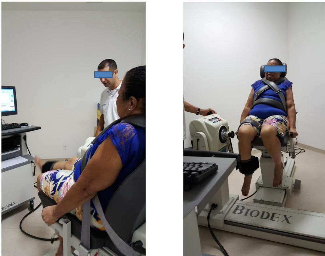
**Figura 2.** Dinamômetro isocinético computadorizado Biodex.
