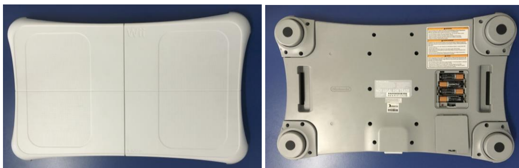
Figura 1: Superfície (painel esquerdo) e localização dos sensores de pressão (painel direito) na Wii Balance Board.
