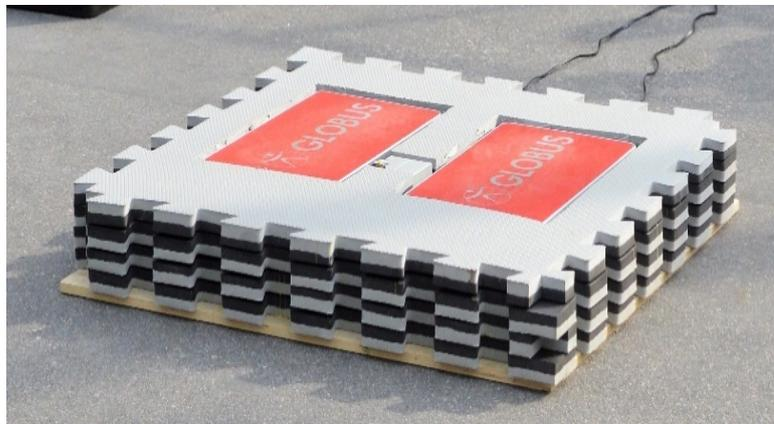
**FIGURA 11** - Representação da plataforma de força com base de madeira e com tapetes de EVA pré-moldados.
