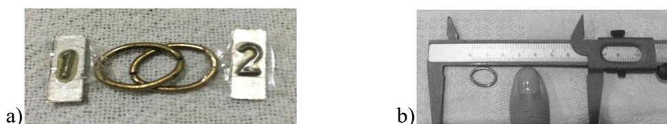
**Figura 2: a) marcadores metálicos de diâmetro elíptico (15 mm no eixo maior e 11 mm no eixo menor) identificados como 1 e 2. b) Paquímetro.**
