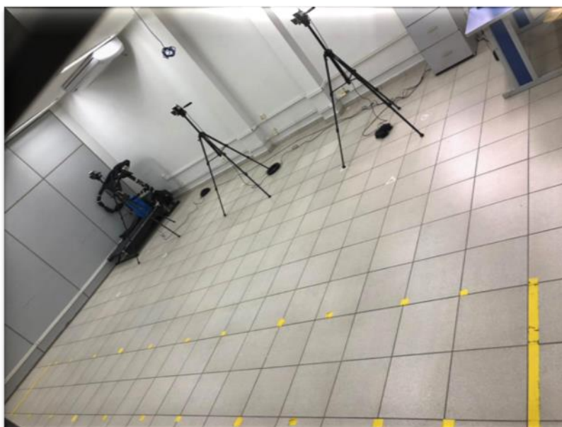
Figura 6 – Análise cinemática da marcha. Área de teste com o posicionamento das 3 câmeras (VICON Nexus 2.5).
