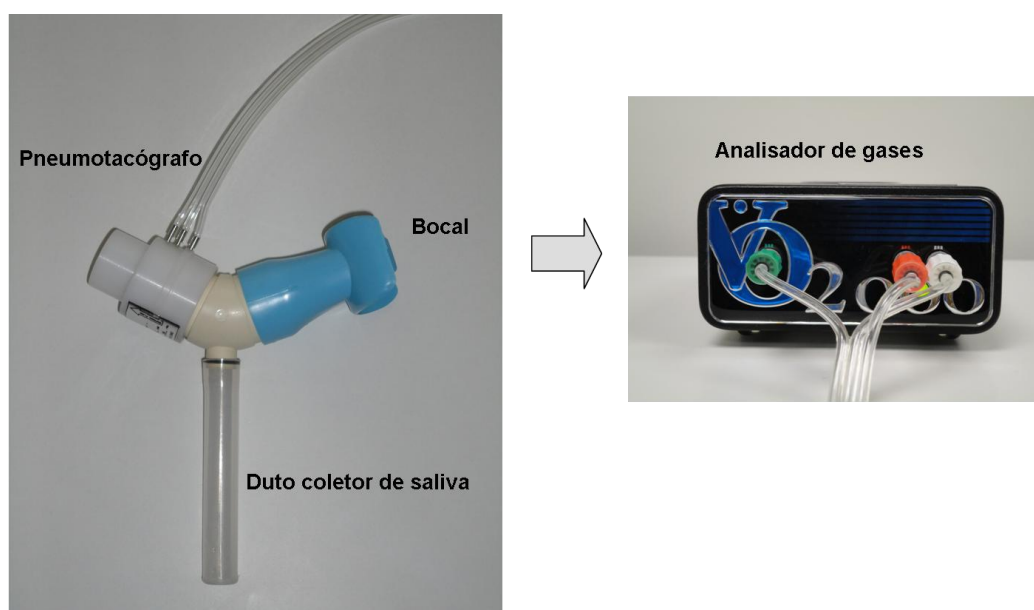
Figura 5 - Equipamento utilizado para a capturação dos gases ventilatórios.
