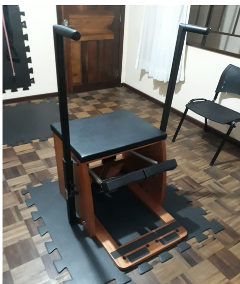
Figura 1 - Equipamentos para exercícios do método Pilates, compostos de roldanas, trilhos e molas de tensões variáveis que criam vetores de forças que se opõem ao movimento: Reformer (A), Cadillac (B), Chair (C) e Barrel (D).
