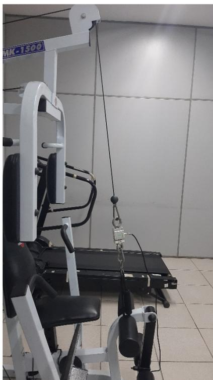
**Figura 5.** Estação de Musculação da unidade de Ciências da Reabilitação da Unisuam com célula de carga acoplada a roldana superior.
