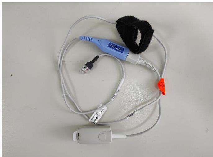
**Figura 12: Oxímetro e cabeamento. FONTE: Próprio autor.**
