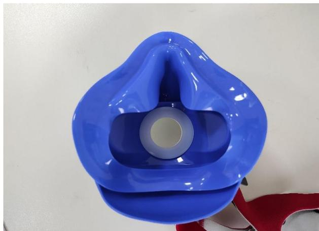
**Figura 7: Máscara de silicone, face posterior. FONTE: Próprio autor.**
