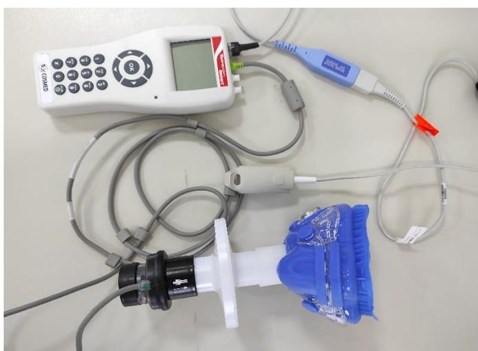
Figura 16: Oxímetro, máscara com filtro e válvula expiratória conectados ao Spiropalm®. FONTE: Próprio autor.
