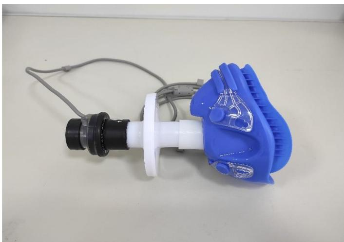
**Figura 10: Máscara conectada ao filtro e válvula expiratória (face inferior). FONTE: Próprio autor.**
