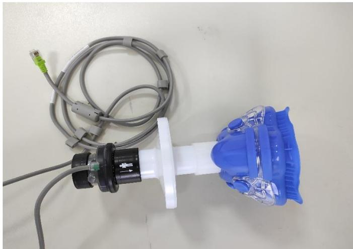
**Figura 11: Máscara conectada ao filtro e válvula expiratória (face superior). FONTE: Próprio autor.**
