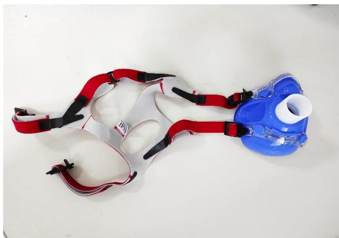
**Figura 8: Máscara de silicone com alça elástica ajustável. FONTE: Próprio autor**
