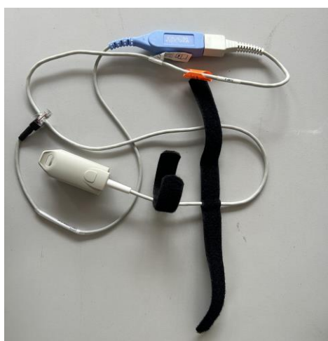
Figura 9: Oxímetro e cabeamento. FONTE: Próprio autor.
