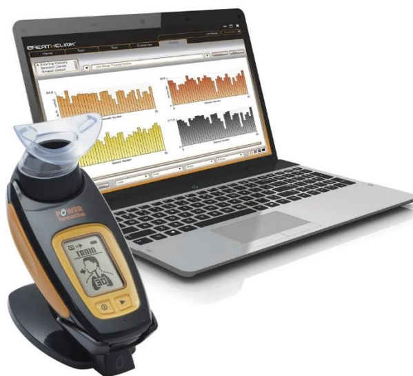
Figura 5: Equipamento de avaliação do índice de pressão inspiratória dinâmica digital K5 series para avaliação do S-Index (HaB International Londres, Reino Unido. Fonte: Autores (2022).
