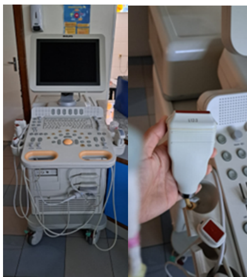
Figura 1. Aparelho de ultrassom da marca Philips, HD7, com transdutor linear de alta frequência (8-12 MHz).
