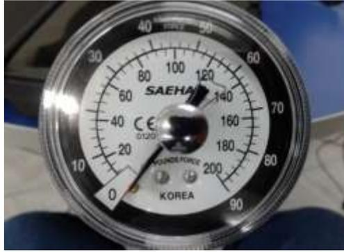
Figura 7: Foto do manômetro do dinamômetro Saehan.
