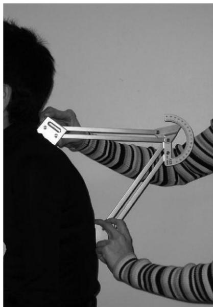
**Figura 16.** Cifômetro de Debrunner como instrumento de medida da cifose torácica (KADO et al., 2006).
